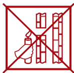
слабая тяга (Не используйте котел!)
