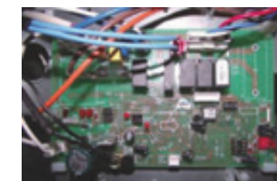
Плата управления внешнего блока
