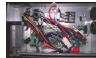
Плата управления внутреннего блока
