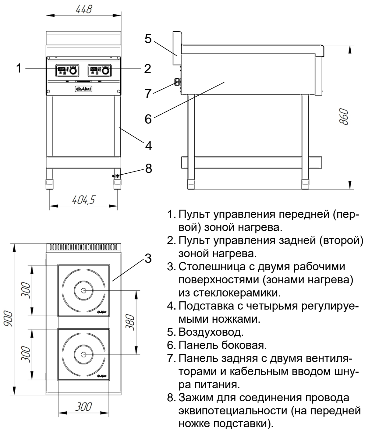
Рис. 1. Общий вид и размеры плит КИП-29П-3,5, КИП-29П-3,5-01, КИП-29П-5,0, КИП-29П-5,0-01
