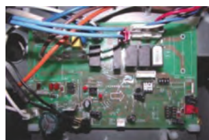
Плата управления наружного блока
