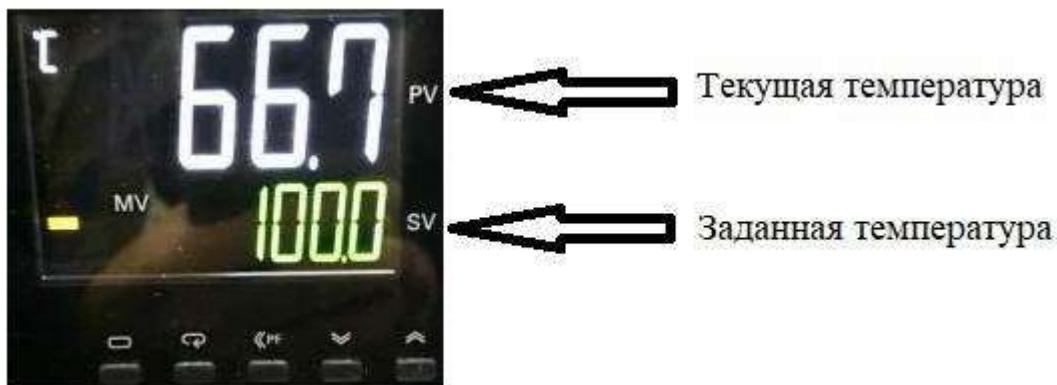
6. Убедитесь в том, что на дисплее контроллера температуры горит индикатор “OUT”. Он означает, что нагревательные элементы работают. Когда температура в камере печи достигает 90°C на дисплее контроллера загорается индикатор “SUB1”.
