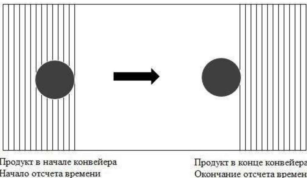
Засеките время, которое потребуется продукту для перемещения от начала конвейера в его конец. Таким образом время перемещения продукта определяет скорость конвейера. Именно это значение и отображается на цифровом контроллере скорости движения конвейера.
