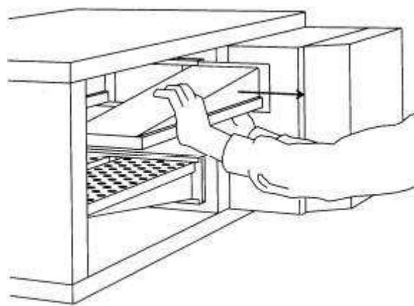
Обратите внимание на то, что нагревательные пластины состоят из нескольких элементов. Обязательно промаркируйте все пластины, которые вы извлекаете из печи, чтобы затем собрать их в том же порядке после проведения очистки. Это очень важно, будьте очень внимательны и старайтесь не путать пластины между собой. Мы рекомендуем использовать следующую маркировку:
