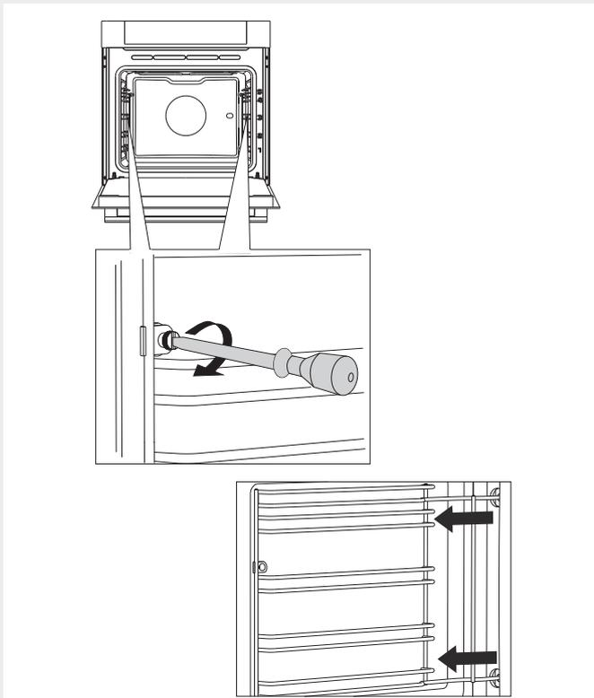
**1** Открутите винт с помощью отвертки.
