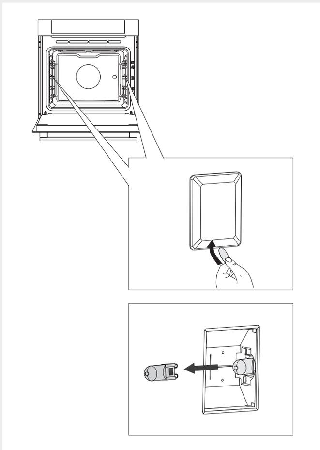
**1** С помощью отвертки снимите крышку.
