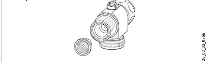
Montaje del filtro
