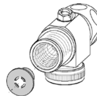
Montaż ogranicznika ilości przepływu
