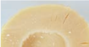
Стандартная заморозка Видны пустоты
