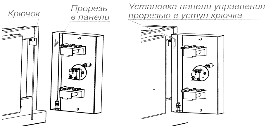
Рис.6 Схема установки панели управления при ТО
