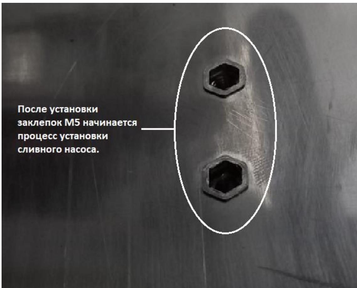
После установки заклепок M5 начинается процесс установки сливного насоса.
