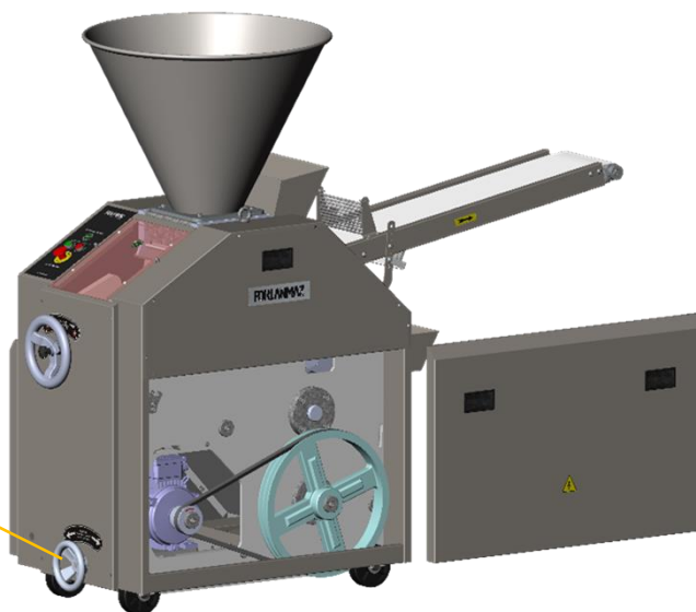
Рисунок 13 Ослабление натяжения ремня
