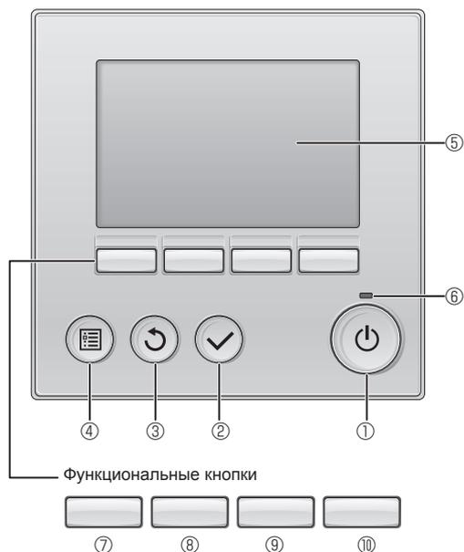
Функции функциональных кнопок меняются в зависимости от экрана. См. подсказку по функциям кнопок, которая отображается в нижней части ЖК-экрана для функций, которые работают в данном окне.
