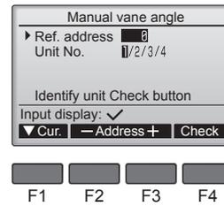
① Во-первых, параметр "Ref. address" (Адрес обращ.) должен быть равен 0, "Unit No." (Устр. №) – 1.
