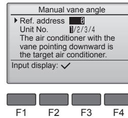
② Установите порядковый номер устройства "Unit No." (Устр. №) и проверьте каждое устройство.
