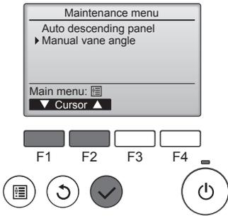
② С помощью кнопки [F1] или [F2] выберите "Manual vane angle" (Ручная установка угла), затем нажмите кнопку [ВЫБОР].
