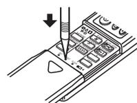
Нажмите кнопку Reset (Сброс) с помощью предмета с узким концом.
