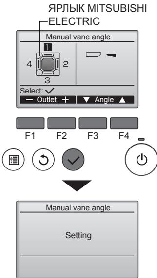
④ Отобразятся текущие настройки угла дефлектора.
