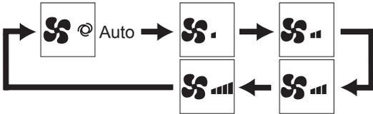
• Возможные скорости вентилятора зависят от моделей подключенных внутренних блоков.
