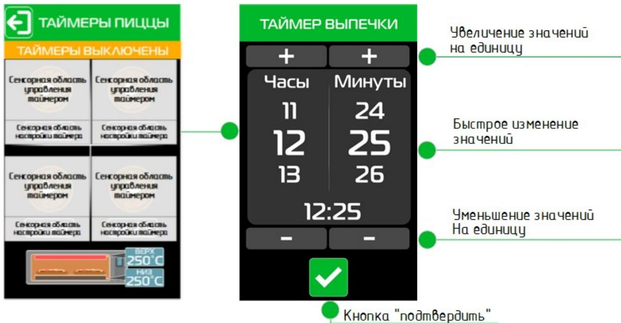
Настройка времени таймеров осуществляется нажатием на соответствующую сенсорную область для каждого таймера. Значения выбираются скроллингом – это увеличивает скорость настройки параметров, дополнительно есть возможность изменить значение с точностью до единицы при помощи кнопок «+» и «-». Для подтверждения выбора следует нажать на кнопку «подтвердить». Все параметры можно изменять в процессе работы каждого таймера.
