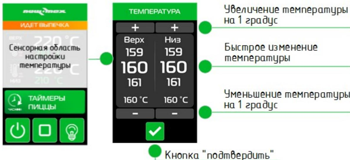
Настройка температурных параметров выпечки осуществляется нажатием на соответствующую область. Значения выбираются скроллингом – это увеличивает скорость настройки параметров, дополнительно есть возможность изменить значение с точностью до единицы при помощи кнопок «+» и «-». Для подтверждения выбора следует нажать на кнопку «подтвердить».
