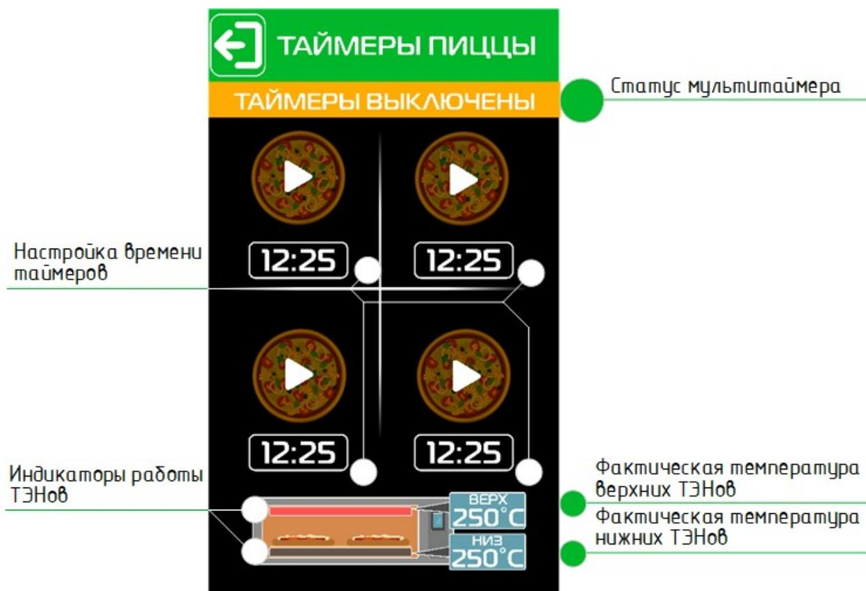
Данная функция позволяет оптимизировать процесс выпечки пиццы переложив контроль за временем приготовления на электронный пульт управления. Интерфейс мультитаймера предоставляет пользователю возможность настройки до 4-х таймеров с независимым друг от друга функционированием.
