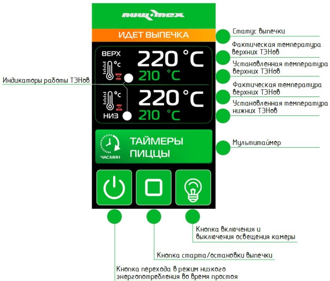
Главная страница интерфейса предлагает пользователю возможности управления температурой верхнего и нижнего ТЭНов, лампой освещения в камере и переходом в режим низкого энергопотребления. Обратите внимание, что при переходе в данный режим отключатся все нагревательные элементы и лампа освещения, а также уменьшится яркость дисплея. Для возврата в главное меню достаточно нажать на любую точку на экране.
