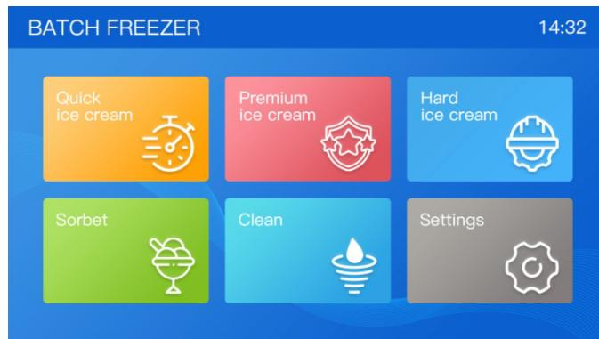
После включения питания коснитесь экрана, чтобы перейти в режим ожидания, нажмите соответствующую кнопку для входа.
