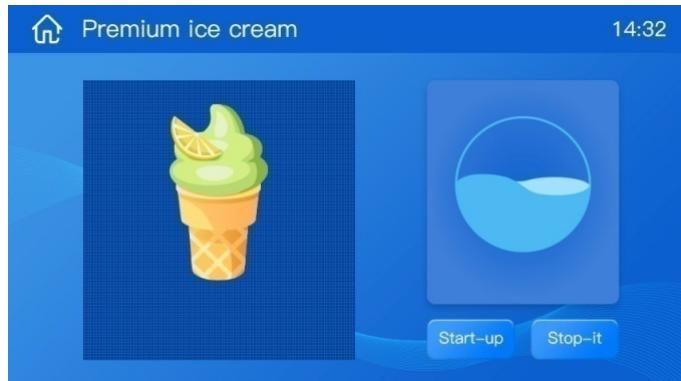
Нажмите кнопку «Start-up / Пуск», включится перемешивание, и после 5-секундной задержки включится компрессор, а значок перемешивания и снежинки отображаются динамически. В строке меню отображается ход приготовления мороженого. Когда твердость мороженого достигает установленного значения, на экране появляется окно с подсказкой «request out / запрос выгрузки» и раздается звуковой сигнал в течение 15 секунд.
