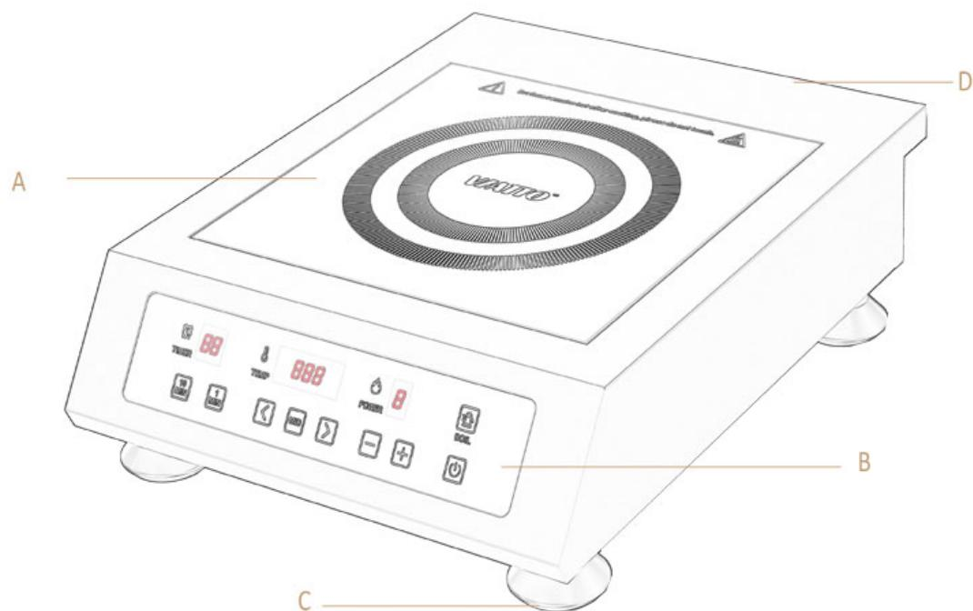
А. Стеклянная панель В. Контроллер С. Ножки D. Внешний корпус
